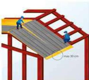
4.- Para mejores resultados, colocar la lámina en forma paralela al aislamiento con una distancia aislante-lámina de 14" aproximadamente como se muestra en la imagen. Se recomienda utilizar Foamular® de Owens Corning para evitar la formación de puentes térmicos; este espacio deberá estar cerrado de forma que no permita corrientes de aire.
