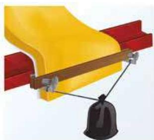
1.- Fijar un extremo del ATITM Fiberglass® Aislamiento para Techos Industriales a lo ancho de la estructura con la cara recubierta con el foil de aluminio hacia el exterior de la construcción.
