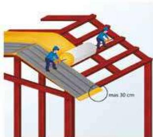
2.- Desenrollar. Esta operación debe realizarse dando una ligera tensión con el objeto de que la superficie quede prácticamente plana (no aplicar tensión excesiva ya que se puede rasgar o deformar la película).
